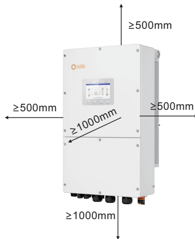
Figura 3.5 Distancias de montaje del inversor
