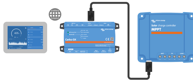
Conexión de la aplicación VictronConnect por LAN o Internet (VRM Portal) con un dispositivo GX (por ejemplo, un Cerbo GX)
