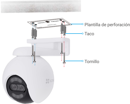
Fig. 1 Montaje en el techo
