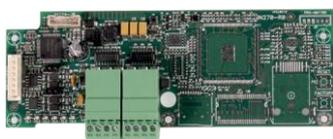
**PREVIDIA-C-COM** ofrece dos puertos RS232 y dos puertos RS485 donde conectar comunicadores remotos mediante los protocolos indicados en la tabla.
