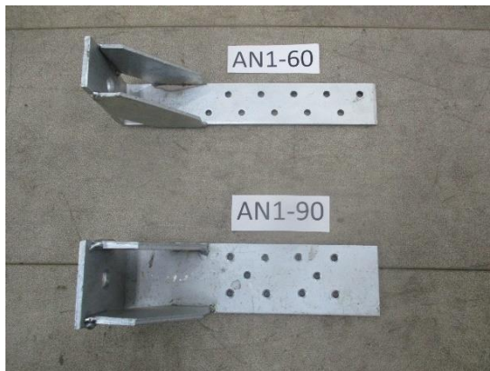
Foto N°1: Soportes viga recibidos
