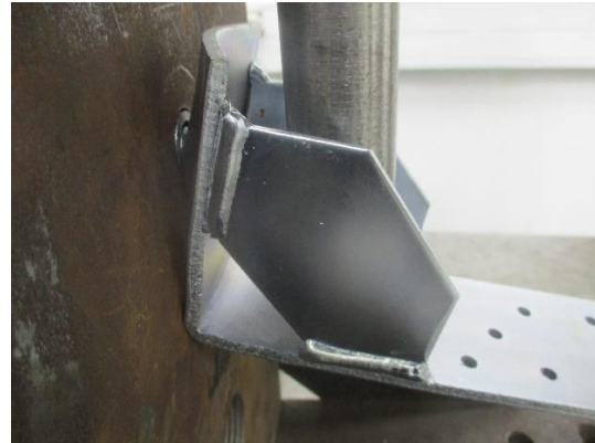
Foto N°5: Muestra AN1-90 deformación del soporte en fuerza máxima
