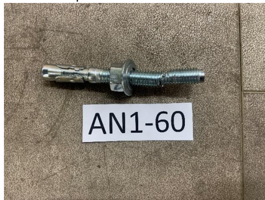
Foto N°7: Corte del perno de anclaje de la muestra AN1-60 después de ensayado.
