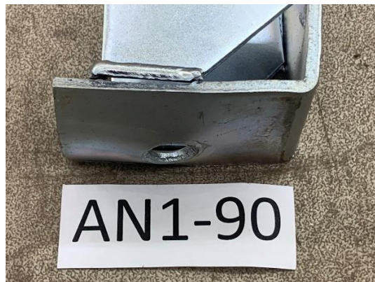
Foto N°8: Muestra AN1-90 desgarró de la soldadura.
