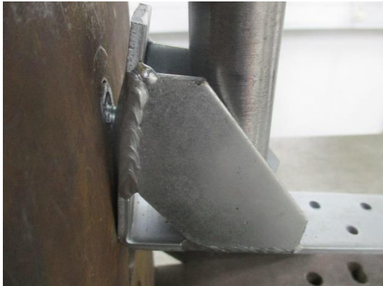
Foto N°4: Muestra AN1-60 deformación del soporte en fuerza máxima
