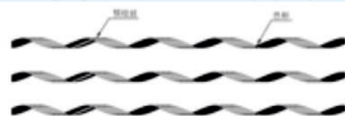
铝绞线 (LJ) 的接续条、镀锌钢绞线、铝包钢绞线的地线接续条
