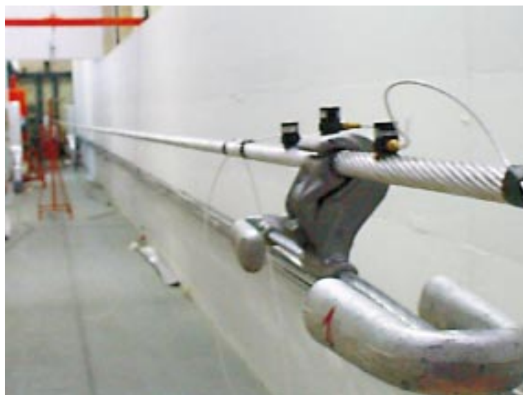
Ensayo de efectividad del amortiguador. Damper effectiveness evaluation test. Essais d'évaluation de l'efficacité de l'amortisseur.
