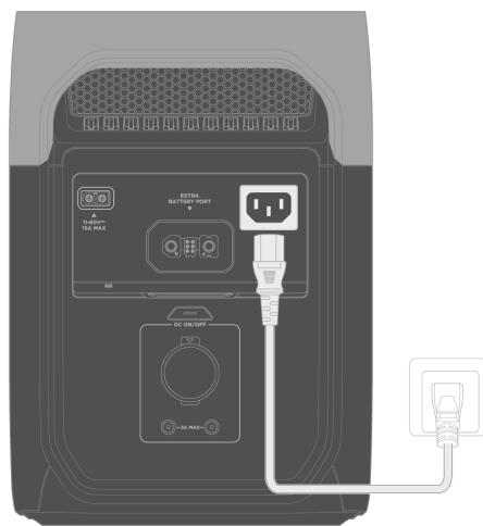
Conecte el puerto de entrada de CA de la estación de energía a un tomacorriente de pared usando el [cable de carga de CA](#) proporcionado.
