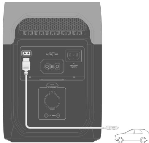
Para evitar un fallo de arranque debido a que no hay batería suficiente, conecte el cable de carga después de arrancar el vehículo. Además, asegúrese de que el cable esté conectado de manera correcta al encendedor de cigarrillos.
