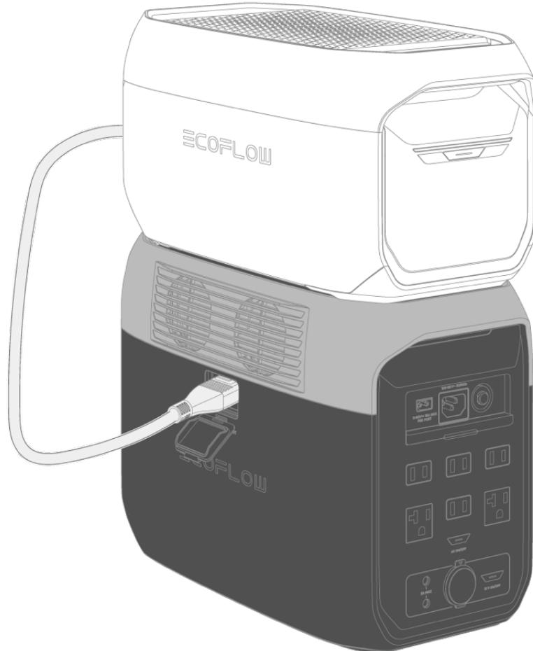
1. Conecte la batería adicional al puerto de la batería adicional de la estación de energía.
