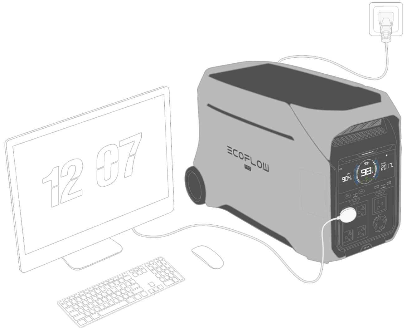
**Nota:** En esta configuración, la estación de energía necesita una mayor entrada de potencia de la red eléctrica de la que proporciona a cualquier carga conectada, por lo que puede utilizar la energía sobrante para cargar y mantener sus baterías. De lo contrario, la estación de energía no podrá funcionar como SAI ya que sus baterías no tendrán carga.
