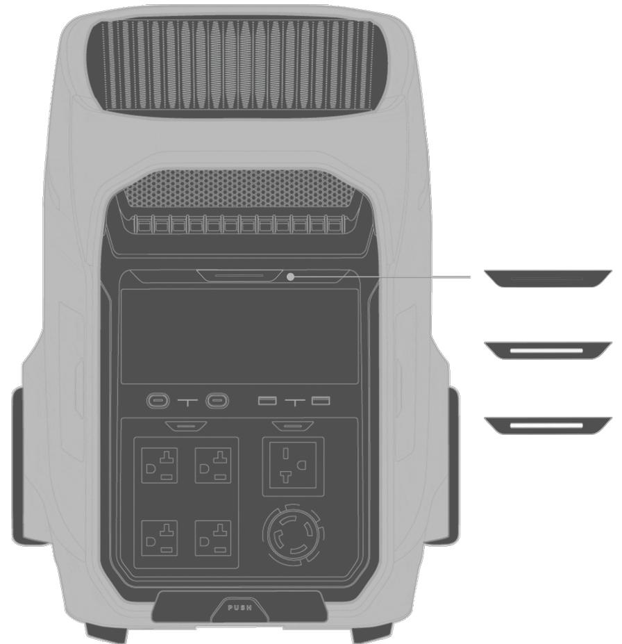
**Desactivado:** La estación de energía está apagada.
