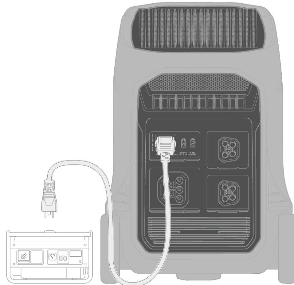
**Método 3: A través del puerto de ENTRADA / SALIDA de CA**
