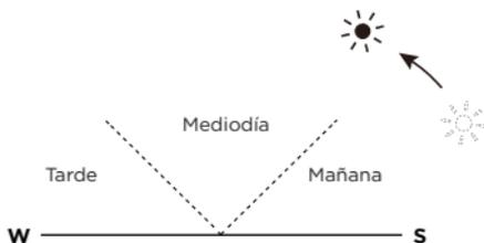
La función de soporte solo debe utilizarse antes de las 10:00 o después de las 14:00. Para utilizar el producto al sol del mediodía, solo tiene que colocar el panel solar en el suelo.
