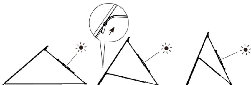
Para mejorar los resultados de carga, la funda de protección también se puede utilizar como soporte para sostener el panel solar en un ángulo de  $30^\circ$ - $80^\circ$ .
