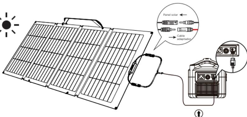
Este cable sólo puede utilizarse para la conexión entre los paneles solares y el almacenamiento de energía.
