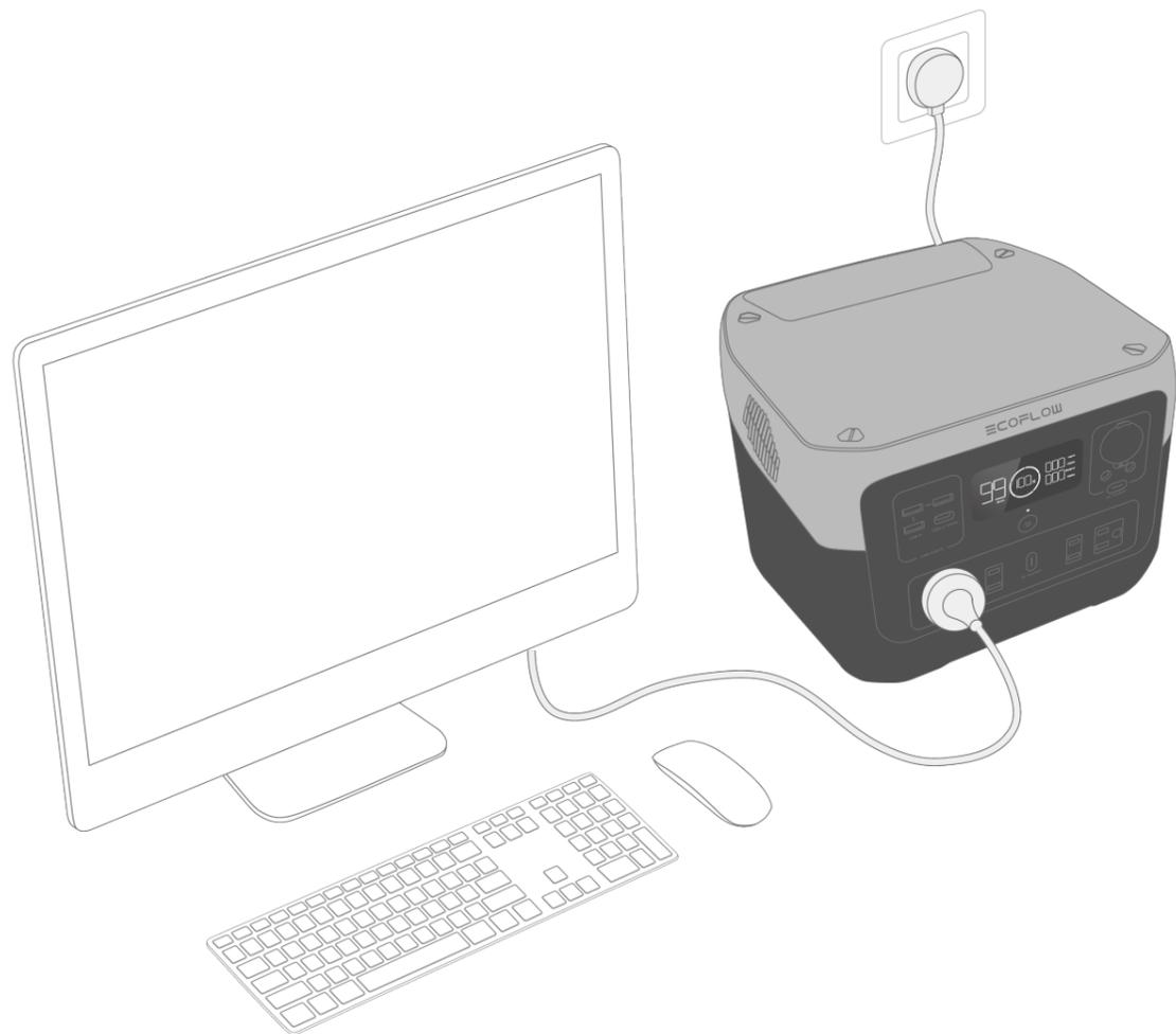
En caso de un apagón repentino, el producto puede cambiar automáticamente al modo de alimentación por batería en 30 ms.
