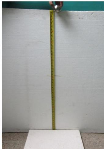
Fotografía 1: probeta de M1 durante ensayo de impacto a 102 cm de altura.
