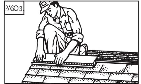
**3.** Centre la ventilación sobre la ranura. El extremo debe quedar al mismo nivel que el extremo del techo. Asegúrese de que las estrías de soporte de la ventilación queden planas sobre el techo y que el filtro (si está incluido) quede firme entre las tejas y la ventilación.
